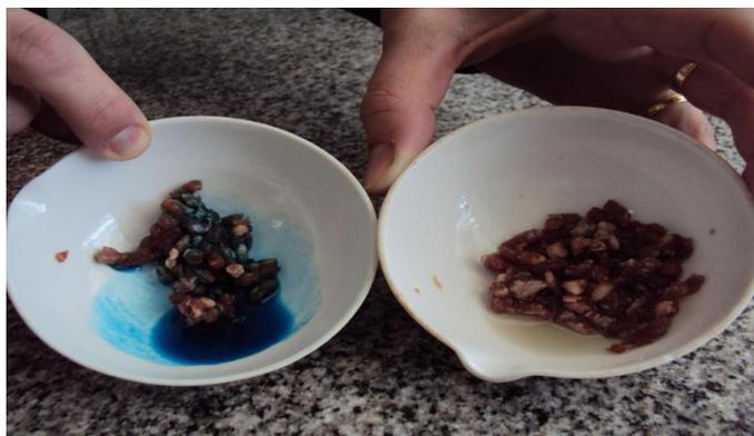
Figura 1: Ensayo de screening de verde de malaquita.
